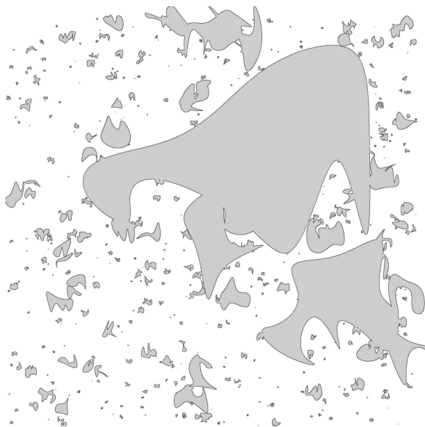
Рис. 3. Пример геоимитационного моделирования поля термокарстовых озер с учетом логнормального закона распределения их по размерам.
